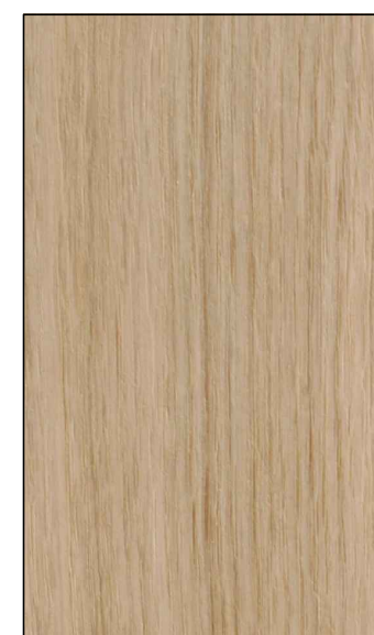
ΤΥΠΙΚΗ ΛΕΠΤΟΜΕΡΕΙΑ ΟΨΗΣ ΚΑΘΕΤΟΥ ΙΣΟΒΕΝΟΥ ΚΑΠΛΑΜΑ ΔΡΥΟΣ
