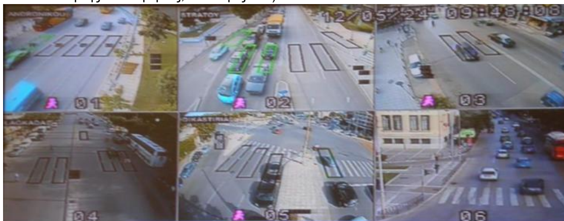
Εικόνα 1-25: Παράδειγμα μη –παρεμβατικού συστήματος συλλογής κυκλοφοριακών φόρτων και σύνθεσης κυκλοφορίας, Θεσσαλονίκη.
